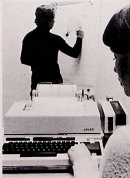
Afb. 1. De nieuwe elektronische verreschrijver 1000 van Siemens is niet alleen moderner, maar ook kleiner, lichter, en niet te vergeten stiller geworden. De centrale besturing ervan bestaat uit zeven MOS-circuits, die speciaal voor dit doel werden ontwikkeld. Via aangepaste aansluitingen kan ook ponsbandapparatuur worden aangesloten, zoals op de foto de ponsers rechts van het apparaat.
